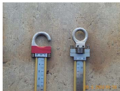
Fig. 9 : Extrémités du ruban (crochet en bas, anneau en haut)
