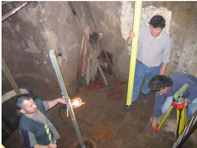
Fig. 15 : mesure avec niveau NA2 dans la crypte, la mire est sur le repère fondamental
