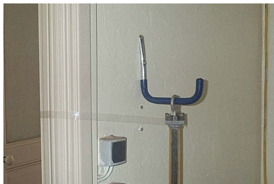
Fig. 19 : partie du ruban invar accrochée au rez-de-chaussée
