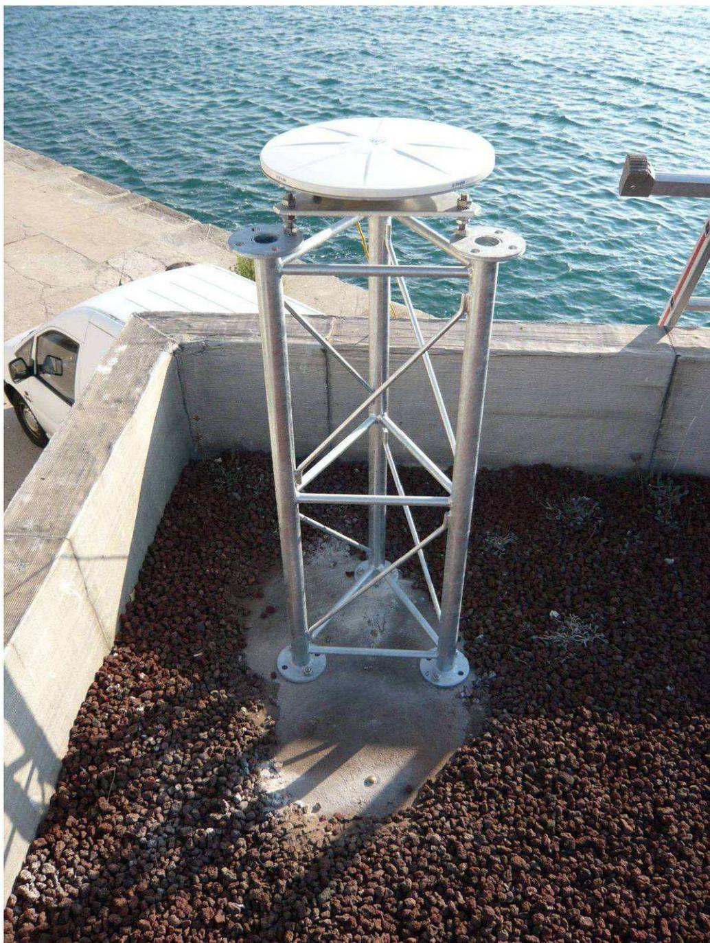
*Exemple d'installation d'une antenne GPS au marégraphe de Sète*
