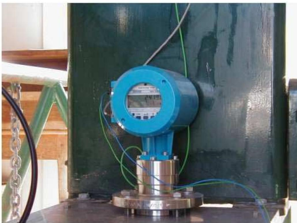
*télémètre radar Krohne BM100.*
