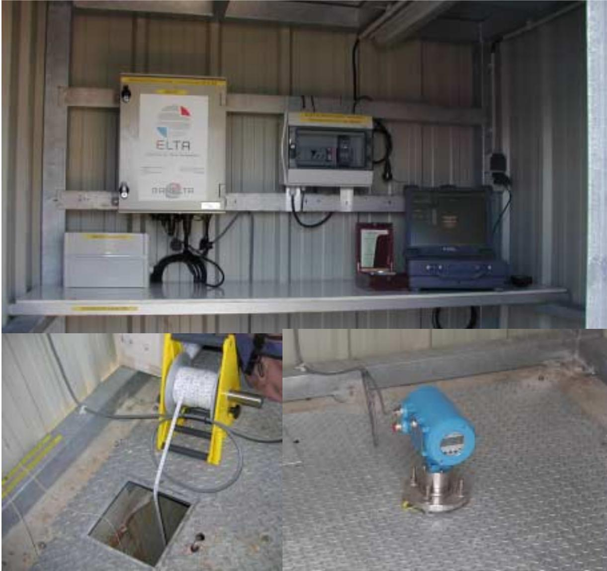
Les mesures à l'échelle de marée ont été perturbées par un clapot important. Les mesures à la sonde lumineuse ont quant à elles été perturbées par l'état visqueux de la surface de la mer dans le puits de tranquillisation. Le diagramme de VDC est représenté sur la figure suivante.
