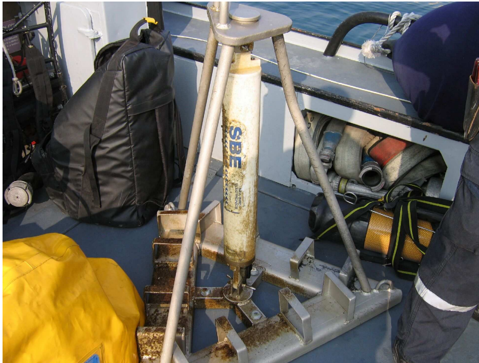
Fig. 2 : Tripode et marégraphe hissés sur le bateau, un des montants est tordu.
