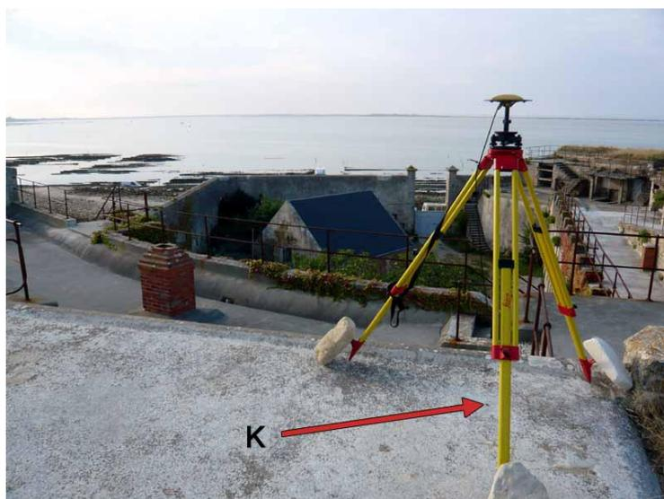
**Description :** boulon en alliage de bronze (comportant une marque de centrage) scellé par une équipe de l'UMR LIENSs le 23 juillet 2009, à proximité de la terrasse des canons, au nord du fort. Il est situé à 69 cm du bord ouest, 82 cm de la rambarde métallique et 130 cm d'un anneau scellé.
