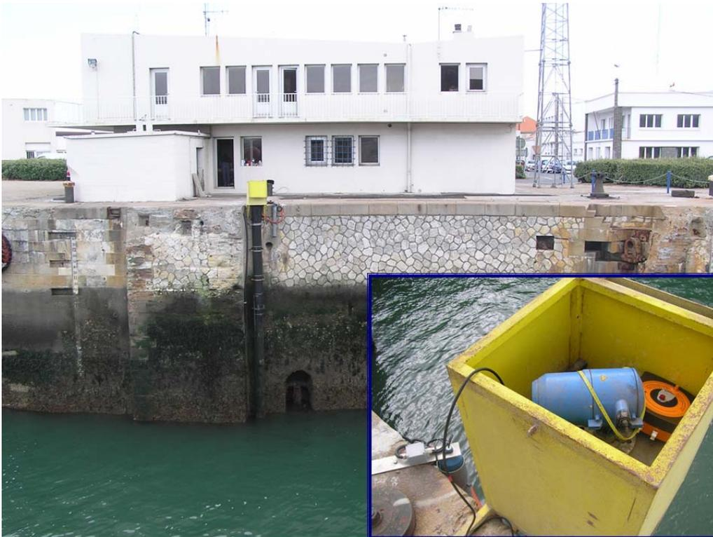
**Fig. 1** : Télémètre radar et puits de tranquillisation du marégraphe de La Pallice.
