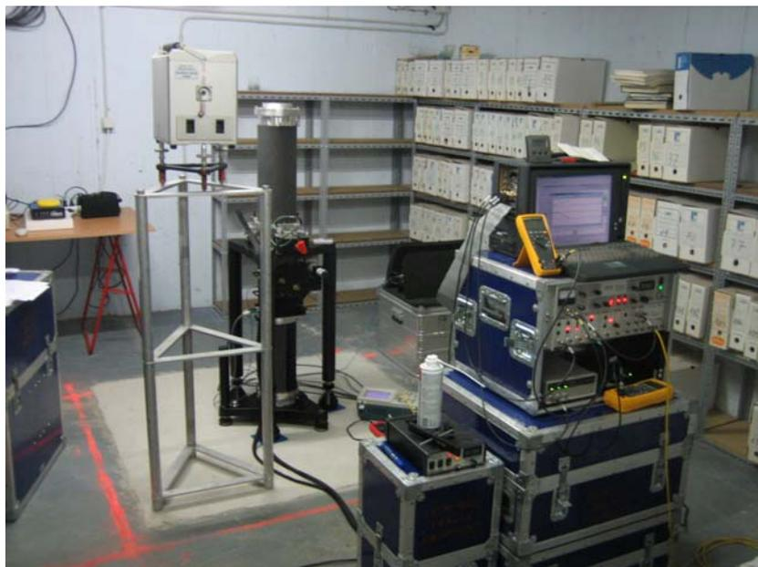
**Fig. 4 :** Gravimètre absolu FG-5 en station à La Pallice (18-21 mai 2006)
