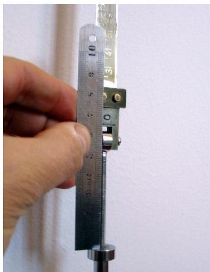
→ **A l'écart du puits**, fixer la sonde au ruban.
