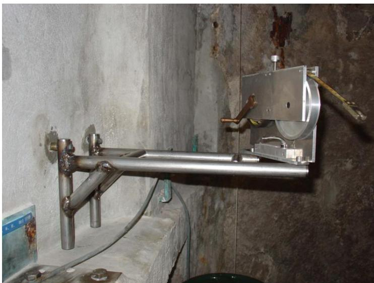
Fig. 9 : installation du portique et du dévidoir du ruban porte-sonde au-dessus du puits.
