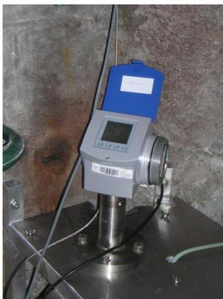
Elle est exploitable par voie téléphonique à l'aide de logiciels pour micro-ordinateurs. La mise en place de la centrale a pour but de recueillir les mesures de hauteur de niveau de la mer à une période d'échantillonnage inférieure ou égale à 10 minutes. Son fonctionnement est permanent. La précision des mesures attendue est meilleure que 2 cm à 99,5 %.
