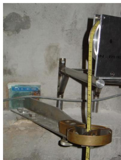
→ Placer deux piles à l'intérieur de la sonde lumineuse et vérifier le fonctionnement de la lampe (bouton de test, voir notice). **Veiller au bon sens des piles, schéma à l'intérieur de la sonde.**
