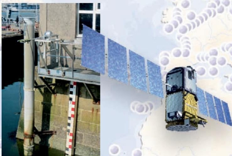
Un marégraphe mesure les variations du niveau de la mer par rapport à la côte. Une station GNSS fournit une position absolue obtenue par satellite. SONEL s'appuie sur ces deux techniques afin d'estimer l'évolution absolue du niveau de la mer.
