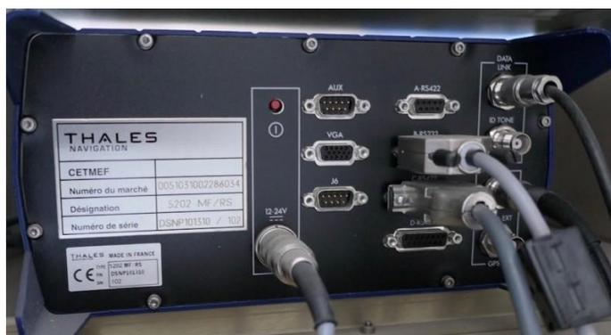
Figure 16 : Façade arrière du récepteur Thalès de FERR
