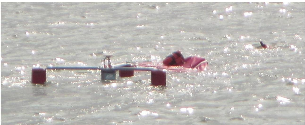
Figure 10 : Micronappe pliée sous l'effet du courant faussant les mesures GNSS.
