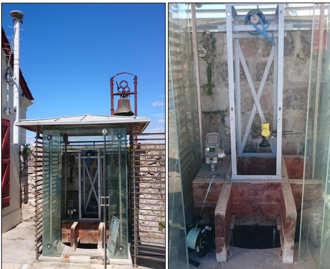
**Fig.2 :** Vue de gauche : marégraphe et antenne GPS permanente (haut à gauche) de Socoa.
