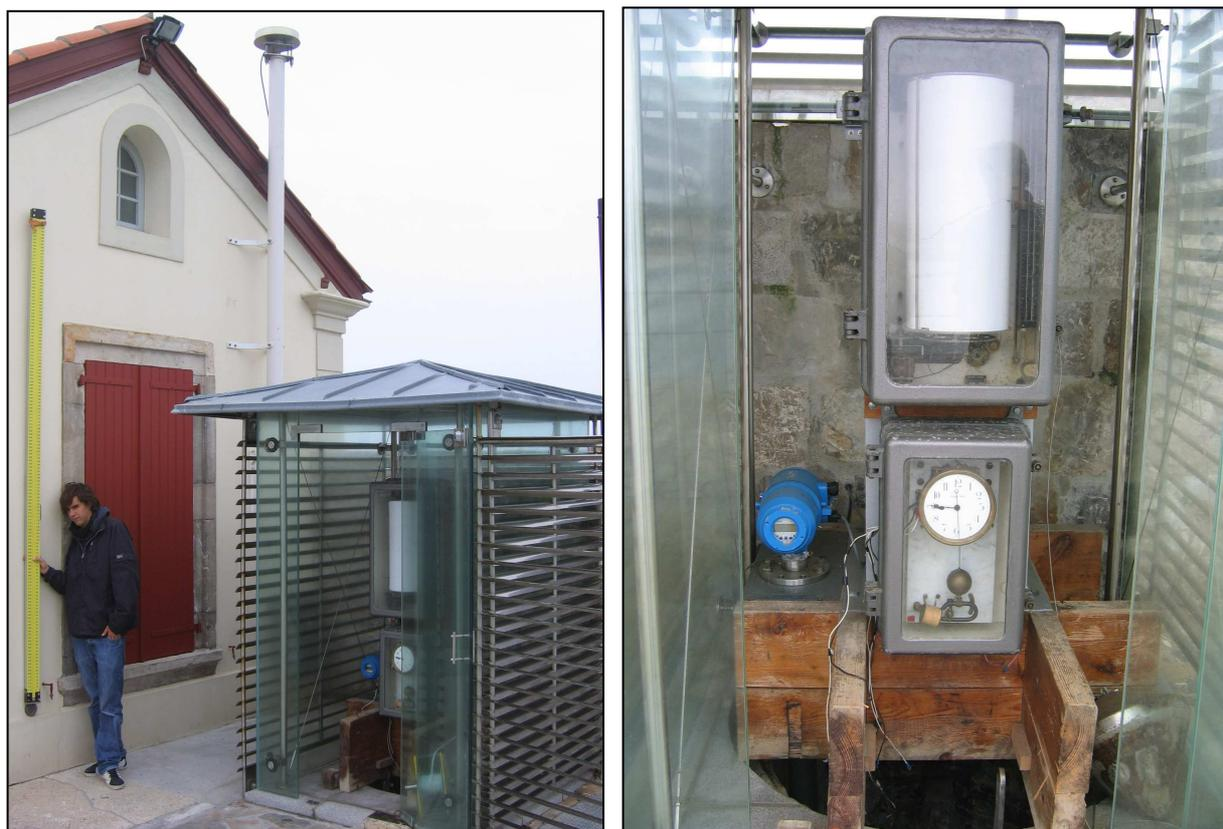
**Fig.1 :** Vue de gauche : marégraphe et antenne GPS permanente de Socoa (la mire est placée sur le repère J).
